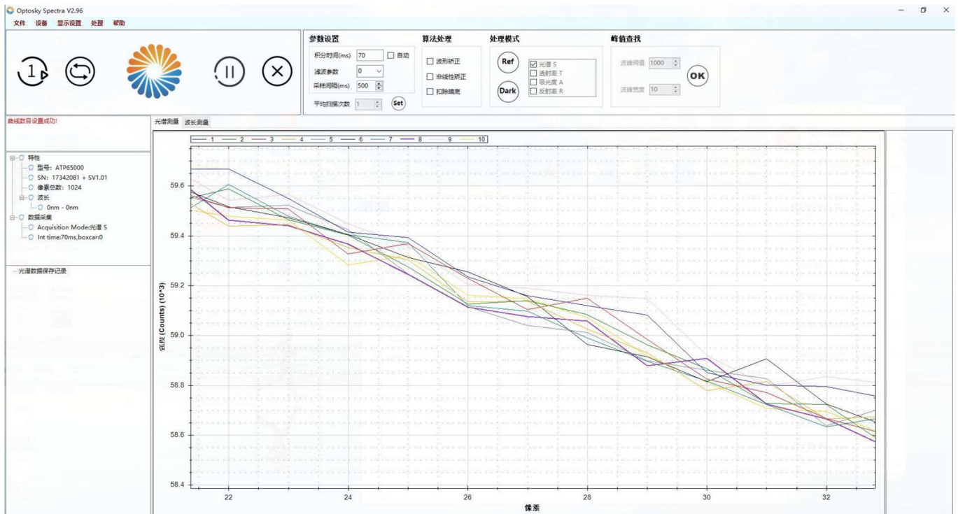
Воспроизводимость 10 последовательных измерения АТР6500 спектрометра (50 кратное увеличение)
